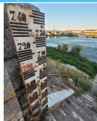
L'échelle limnimétrique de la station hydrométrique de la Loire à Blois (France)
