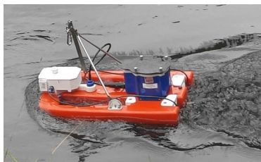
Radar vélocimétrique Sommer RP30 sur drisse
