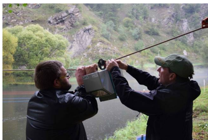
Radar vélocimétrique Sommer RP30 sur drisse
