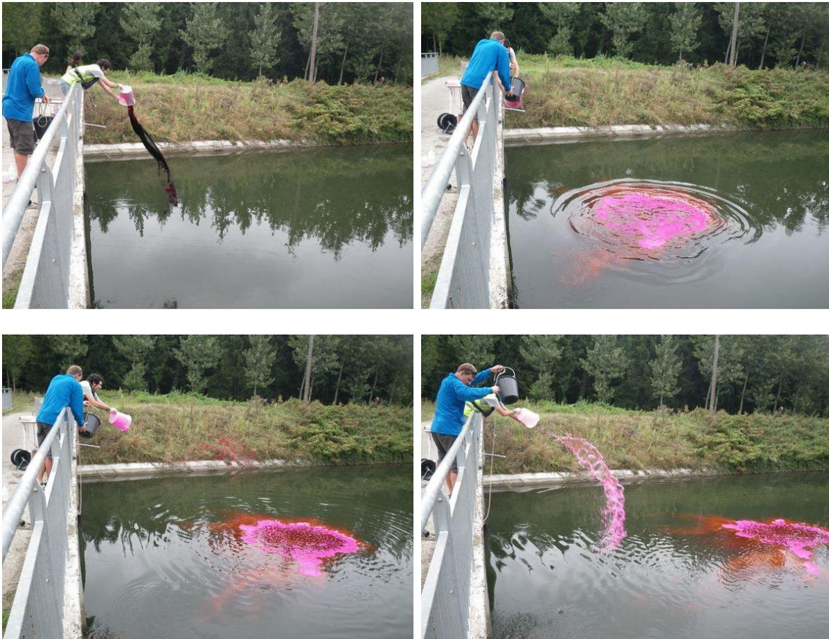
Figure 27 : Injection globale au centre de la section avec rinçage du seuil
