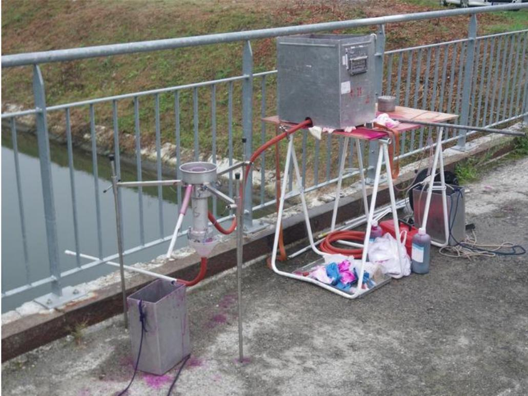
Figure 30 : Le dispositif d'injection pour les traçages à débit constant
