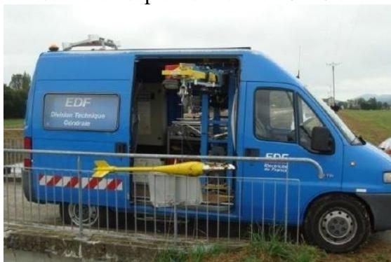
Figure 17 : Mesures au saumon hydrométrique déployé par camion jaugeur
