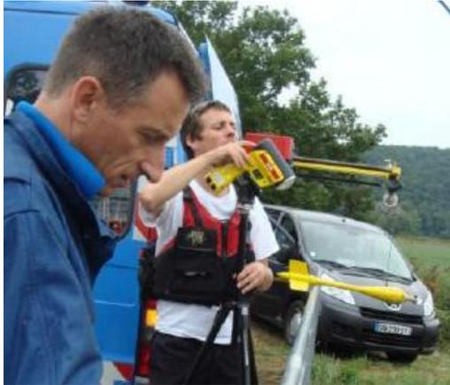
Figure 21 : Visée radar SVR depuis la passerelle avec en arrière-plan le camion-jaugeur
